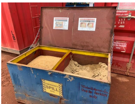
ภาพถ่ายที่ 2.2-5 อุปกรณ์ขจัดครบน้ำมัน
